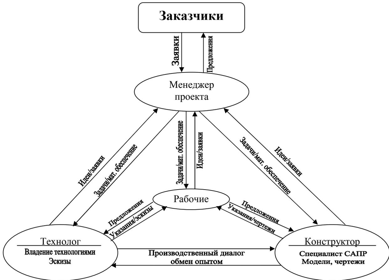
Рис. Схема организационной структуры адаптивно-параллельного метода проектирования образцов новой техники
